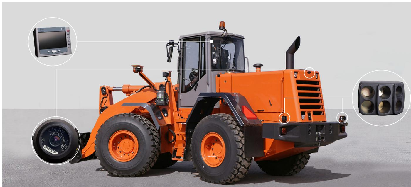
La combinaison de capteurs et de caméra(s) donne au conducteur des informations de sécurité à la fois passive et active sur l'espace libre dans les environs de la machine.
