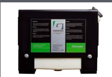
Le Groeneveld Oilmaster surveille le niveau d'huile dans le moteur et, si nécessaire, fournit un volume d'huile prééquilibré mesuré à partir de son propre réservoir.
